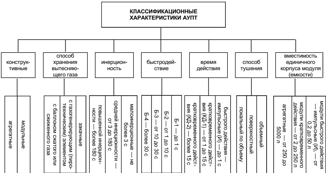
Рис. 2.10. Классификация автоматических установок порошкового пожаротушения
