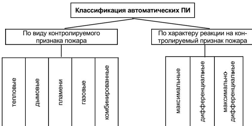
Рис. 2.6. Общая классификация автоматических пожарных извещателей.
